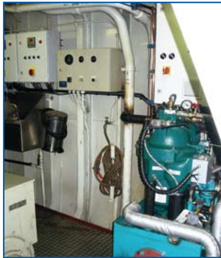
Smeerolieseparator voor de smeeroilie van de hoofdmotor.
